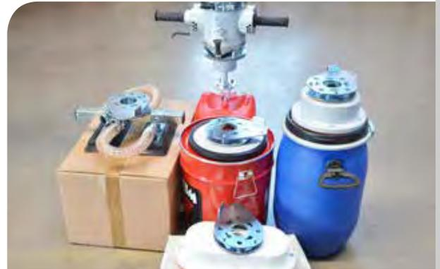
Schnellwechselkupplung für verschiedene Lastaufnahmen
