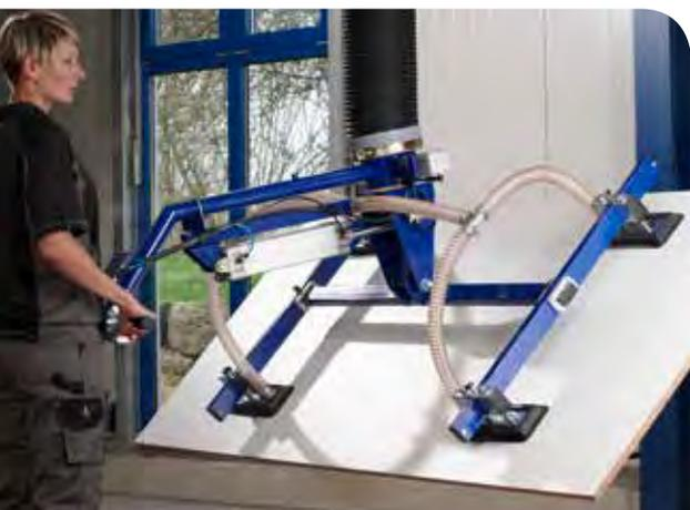
MAXI-LIFT mit Schwenkvorrichtung für Platten bis 300 kg
