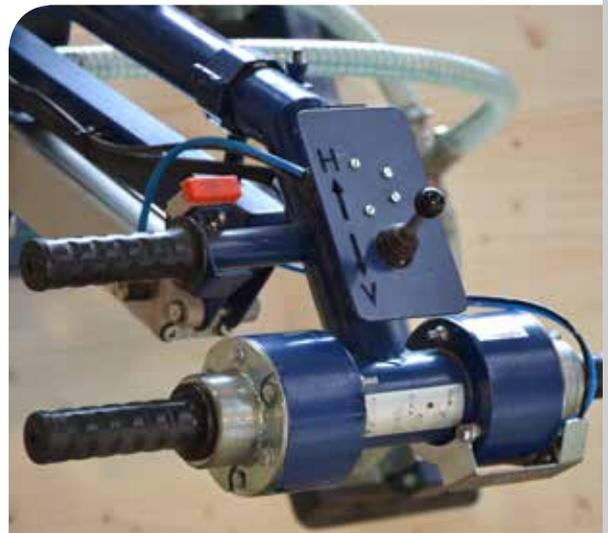
Zwei-Hand-Drehgriff mit Schwenkvorrichtung
