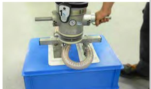
Bedienkopf in V2A mit Funksender
